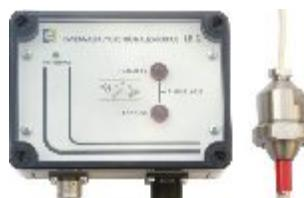
Дополнительно может поставляться автоматический сигнализатор LS-2 для определения количества отделенного жира. Когда толщина слоя жира достигает установленной величины, сигнализатор подает предупредительный сигнал. Сигнализатор также может управлять клапанами и насосами.
